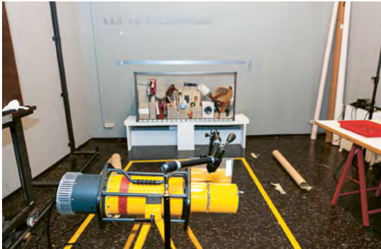
Abb. 9 Blick in die Bleikammer am Institut für Konservierung und Restaurierung, Salzgries. Im Vordergrund die Röntgenröhre „Baltospot“, April 2012
